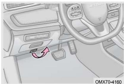
Шаг 1: Капот слегка приподнимется, если дважды потянуть за рычаг открывания капота;
