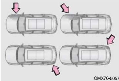
Боковая подушка безопасности переднего сиденья (при наличии) и боковая шторка безопасности (при наличии) могут не сработать, если транспортное средство подвергается боковому столкновению, удару по части задней шины или боковому столкновению под определенным углом к транспортному средству.
