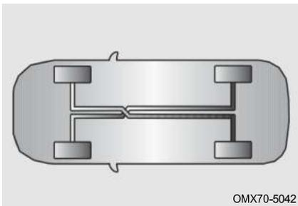
Тормозная система имеет конструкцию типа X, двухконтурную тормозную систему; Система представляет собой гидравлическую систему с двумя независимыми подсистемами. Если одна из подсистем выходит из строя, другая система все еще может выполнять функцию торможения. Однако усилие нажатия на педаль тормоза будет больше обычного, как и тормозной путь, а индикатор неисправности тормозной системы останется включенным.
