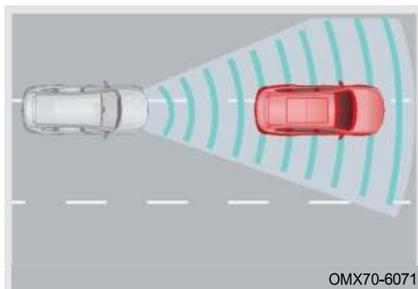
ТJA система: когда скорость автомобиля меньше 60 км/ч, автомобиль будет держаться ближе к центру полосы движения. ICA система: когда скорость автомобиля находится в диапазоне от 60 км/ч до 150 км/ч, автомобиль будет удерживаться в центре полосы движения.
