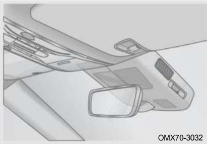
При вождении ночью яркость внутреннего зеркала заднего вида автоматически определяется и регулируется датчиком освещенности, чтобы уменьшить отражение фар идущих сзади автомобилей.
