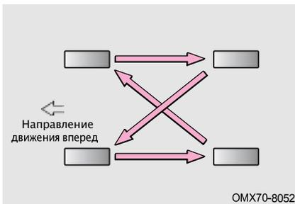
Для выравнивания износа шин и продления срока их службы рекомендуется менять местами шины каждые 10000 км (лучший диапазон регулировки 5000 – 7000 км); Цикл вращения шин может варьироваться в зависимости от манеры вождения водителя и состояния дорожного покрытия.
