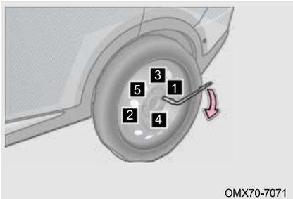
Шаг 4: Используя ключ для колесных болтов, затяните болты в последовательности, показанной на рисунке. Повторите процесс 2-3 раза, чтобы убедиться, что колесные болты затянуты на место;
