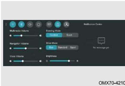
Переведите питание автомобиля в режим ВКЛ, сдвиньте вниз верхний край главного экрана аудиосистемы, чтобы отобразить экран контекстного меню.
