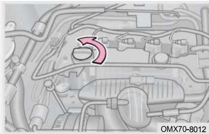
Шаг 1: Поверните крышку заливной горловины масла двигателя против часовой стрелки, чтобы открыть ее;
