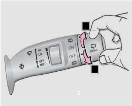
Включите питание автомобиля, потяните и удерживайте комбинированный переключатель стеклоочистителей в сторону рулевого колеса, передний омыватель разбрызгивает воду, и передний стеклоочиститель работает одновременно. После отпускания передний омыватель перестает работать, а стеклоочиститель все еще сбрызгивает несколько раз.
