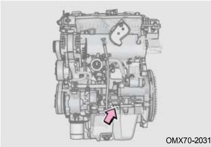
Номер двигателя расположен на блоке двигателя, как показано на рисунке.
