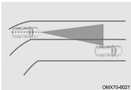
При выходе из поворота передний радарный датчик может среагировать на соседнюю полосу и применить торможение, которое можно прервать нажатием педали акселератора, поскольку система заранее оценит полосу движения.
