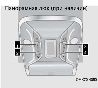
Включите переключатель панорамной люк с электроприводом после переключения питания автомобиля в режим ВКЛ:
