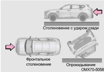
Боковая подушка безопасности переднего сиденья (при наличии) и боковая подушка безопасности (шторка, при наличии) могут не раскрыться, если автомобиль подвергся фронтальному или заднему столкновению, опрокидыванию или боковому столкновению на низкой скорости.
