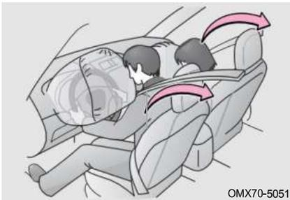
В случае серьезного лобового столкновения подушка безопасности водителя, подушка безопасности переднего лобового пассажира работают вместе с ремнем безопасности, чтобы помочь уменьшить травмы головы или груди водителя и переднего пассажира, вызванные ударом о внутренние компоненты. (Фронтальная подушка безопасности переднего пассажира может быть активирована, даже если на пассажирском сиденье нет человека).
