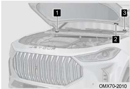
**1** Идентификационный номер автомобиля (VIN) выбит справа на отделке дренажного канала отсека двигателя.
