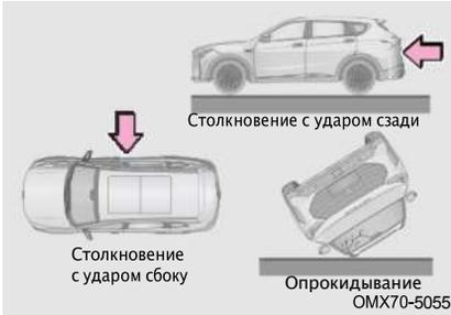
Фронтальная подушка безопасности водителя и фронтальная подушка безопасности переднего пассажира могут не сработать, если автомобиль попал в боковое или заднее столкновение, перевернулся или попал в лобовое столкновение на низкой скорости.
