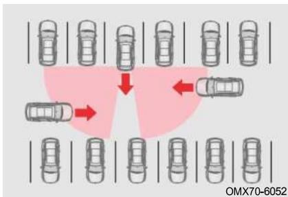
При движении автомобиля задним ходом (передача трансмиссии находится на передаче R), если система BSD обнаруживает, что слева и справа от автомобиля приближаются транспортные средства, светодиодный индикатор обнаружения слепых зон на наружном зеркале заднего вида мигает, информируя водителя о приближении целевого транспортного средства и наличии риска столкновения.
