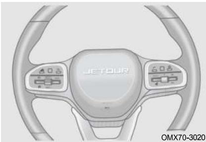
Чтобы подать звуковой сигнал, нажмите на область возле значка звукового сигнала на рулевом колесе.
