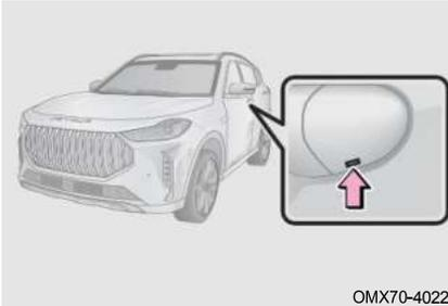
Шаг 1: Вставьте механический ключ в отверстие под крышкой передней левой дверной ручки. Поверните ключ вверх, чтобы снять крышку;
