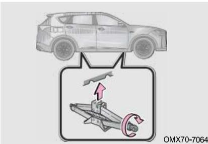
Шаг 3: Установите домкрат на твердую и ровную поверхность, поверните рукоятку домкрата по часовой стрелке рукой, чтобы выемка домкрата коснулась правильной точки подъема домкрата;
