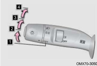
Включите питание автомобиля в режим ВКЛ, поверните комбинированный переключатель фар:
