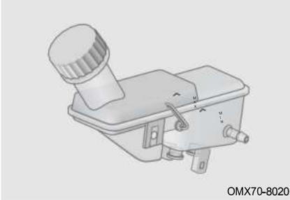
Уровень тормозной жидкости должен находиться между отметками «MIN» и «MAX». Если уровень находится на отметке «MIN» или ниже нее, долейте тормозную жидкость и немедленно обратитесь на авторизованную станцию технического обслуживания Jetour для проверки и ремонта.
