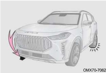
Шаг 1: Поместите блок под шину по диагонали напротив спущенной шины, чтобы предотвратить скатывание автомобиля;
