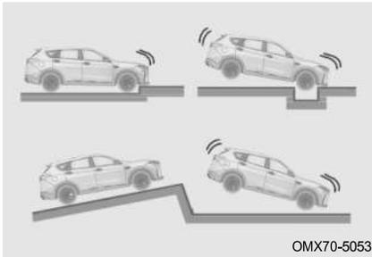
Фронтальная подушка безопасности водителя и фронтальная подушка безопасности переднего пассажира могут сработать в случае удара о нижнюю часть автомобиля.
