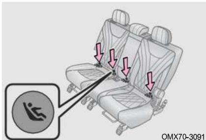
Точка крепления ISOFIX – это система установки детского удерживающего устройства, основанная на стандартах GB 14167 и ECE R14; точки крепления ISOFIX расположены под спинкой наружного сиденья второго ряда; точки крепления обычно расположены рядом с пометкой «ISOFIX» или «
