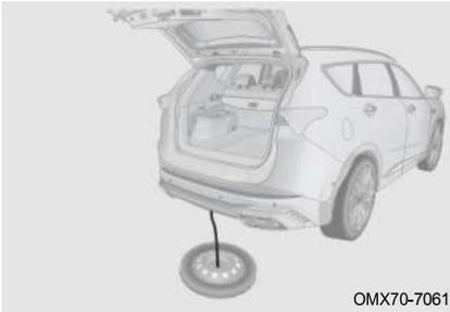
Шаг 4: Выньте крюк устройства крепления запасного колеса и запасное колесо, когда запасное колесо будет опущено в самое нижнее положение.
