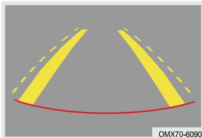
Переведите рычаг переключения передач в положение R, чтобы открыть экран системы контроля парковки, и на экране отобразится монитор обзора парковки и направляющие полосы движения. Указатель полосы движения зависит от поворота рулевого колеса и используется для предварительной оценки траектории движения задним ходом.
