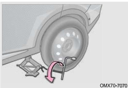
Шаг 3: Убедитесь, что все люди вокруг автомобиля находятся в безопасной зоне, вставьте коромысло домкрата в домкрат, а ключ для колесных болтов в коромысло домкрата и поверните ключ для колесных болтов против часовой стрелки, чтобы опустить автомобиль;
