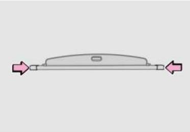
Нажмите на два конца шторки для багажа внутрь, чтобы снять/установить шторку. После того, как шторка снята, ее можно поместить в багажное отделение.
