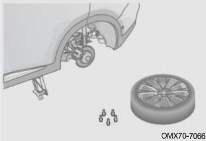
Шаг 5: Снимите колесные болты спущенной шины против часовой стрелки с помощью ключа для колесных болтов и снимите спущенную шину.
