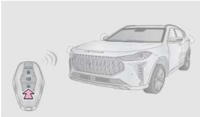
Нажмите кнопку разблокировки на смарт-ключе или коснитесь сенсорной области разблокировки пальцами или подойдите к автомобилю, неся смарт-ключ при себе, система автоматически распознает действительность смарт-ключа и двери автоматически разблокируются, после чего автомобиль выходит из режима постановки на охрану.
