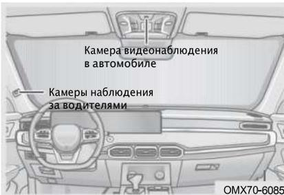
Система мониторинга водителя в основном распознает статус водителя с помощью камеры driver monitor (DMS).
