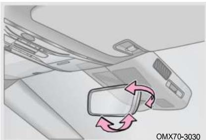
Перед началом движения установите внутреннее зеркало заднего вида в правильное положение, чтобы убедиться, что водитель может обеспечить оптимальный обзор.
