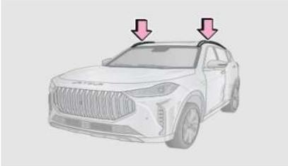
Багажник на крыше используется для погрузки грузов. Убедитесь, что вес загружаемого груза на тележку или погрузочный инструмент (например, багажное отделение, поперечная штанга) не превышает допустимый вес. Избыточный вес приведет к повреждению держателя, стекла люка, крыши кузова и других компонентов, на различные проблемы, вызванные избыточным весом, гарантия не распространяется.
