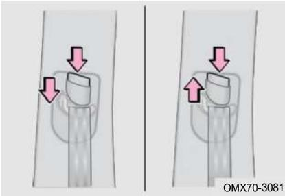
Регулировка вниз: Нажмите регулятор ремня безопасности вниз, одновременно нажимая кнопку регулировки.
