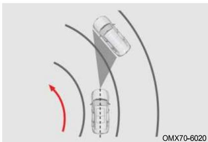
При входе в поворот передний радарный датчик может реагировать на автомобиль на соседней полосе и применять торможение, которое можно прервать нажатием педали акселератора.
