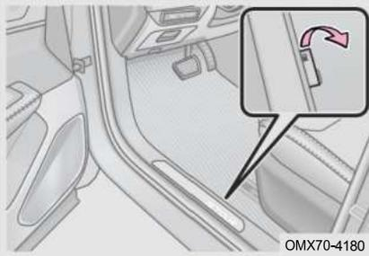
Шаг 1: Потяните ручку крышки топливного бака, и крышка топливного бака выскочит;
