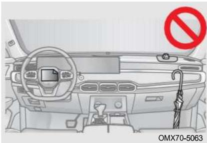
Ничего не прикрепляйте или прислоняйте к таким областям, как приборная панель, рулевое колесо и нижняя часть приборной панели. Эти предметы могут быть выброшены при срабатывании фронтальной подушки безопасности водителя или переднего пассажира.
