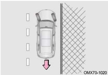
Если на обочине есть бордюр, поверните рулевое колесо влево, чтобы задняя часть переднего правого колеса приблизилась к бордюру или уперлась в него, чтобы предотвратить скольжение автомобиля назад по склону, затем включите стояночный тормоз.
