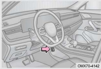
Передний USB-порт расположен на передней панели вспомогательной панели управления.
