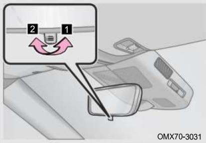
Перед поездкой в ночное время переведите рычаг внутреннего зеркала заднего вида в положение с антибликовым покрытием, чтобы уменьшить отраженный свет от фар идущих сзади автомобилей.
