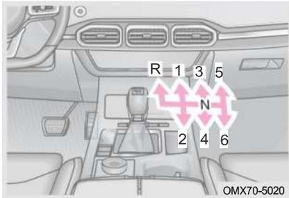
Шаг 1: Полностью выжмите педаль сцепления и педаль тормоза, затем переключите рычаг переключения передач на нужную передачу;
