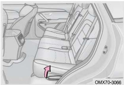
Шаг 1: Сначала прислонитесь на спинку сиденья, затем потяните рычаг регулировки спинки сиденья вверх;
