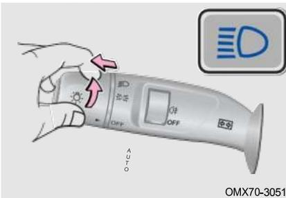
Включите питание автомобиля в режиме ВКЛ., при включении ближнего света потяните комбинированный переключатель фар со стороны рулевого колеса и отпустите, загорится дальний свет; Потяните комбинированный переключатель фар в сторону рулевого колеса и отпустите, чтобы выключить дальний свет.
