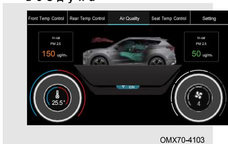
Если концентрация твердых частиц в автомобиле высока, система предложит вам включить функцию очистки воздуха. Нажмите кнопку «ION», чтобы включить функцию очистки воздуха.
