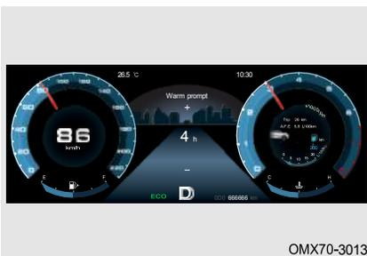
Шаг 1: На интерфейс настроек сдвиньте сенсорную кнопку «
