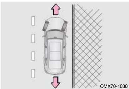
Если на обочине нет бордюра, поверните рулевое колесо вправо на большой угол, чтобы предотвратить выезд автомобиля на середину дороги после скольжения вперед/ назад по склону. Поверните рулевое колесо в сторону дороги так, чтобы при движении автомобиль находился далеко от центра дороги, затем нажмите на стояночный тормоз.
