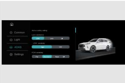
Помощь при перестроении: Установите предупреждение о выезде /удержании полосы движения/ВЫКЛ.
