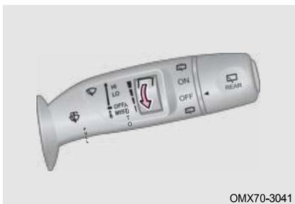
Автоматический режим «AUTO» (при наличии): Датчик дождя регулирует скорость работы стеклоочистителя в зависимости от количества осадков.
