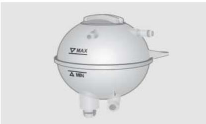
При холодном двигателе уровень охлаждающей жидкости должен находиться между отметками «MIN» и «MAX». Если уровень находится на отметке «MIN» или ниже нее, долейте охлаждающую жидкость и немедленно обратитесь на авторизованную станцию технического обслуживания Jetour для проверки и ремонта.
