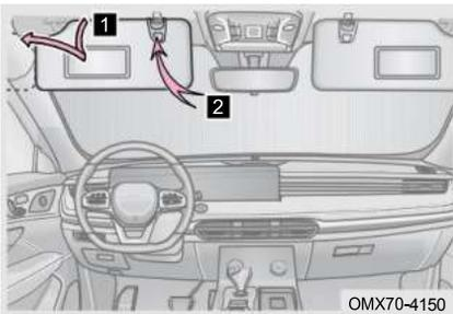
Горизонтально переместите выдвижную пластину зеркала для суеты, чтобы использовать зеркало для суеты. Для автомобиля, оснащенного подсветкой зеркала заднего вида, соответствующая подсветка зеркала заднего вида загорается при перемещении выдвижной пластины зеркала заднего вида.
