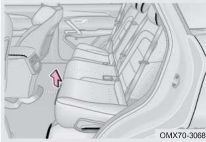
Шаг 1: Потяните регулировочную рукоятку в переднем и заднем положениях сиденья вверх;
