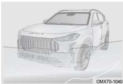
Автомобиль может быть серьезно поврежден при движении по дороге, затопленной после сильного дождя. Если движение по воде неизбежно, проверьте глубину воды и двигайтесь медленно и осторожно.
