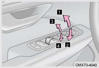
Включите переключатель стеклоподъемника после переключения питания автомобиля в режим ВКЛ:
