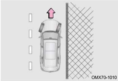
Если на обочине есть бордюр, поверните рулевое колесо вправо, чтобы передняя часть переднего правого колеса приблизилась к бордюру или уперлась в него, чтобы предотвратить скольжение автомобиля вперед по склону, затем включите стояночный тормоз.
