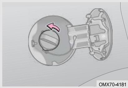
Шаг 2: Поверните крышку топливного бака против часовой стрелки, чтобы снять её;
