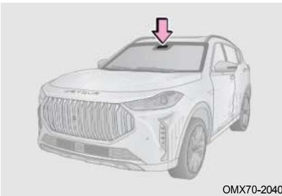
Микроволновое окошко расположено с внутренней стороны переднего лобового стекла и с правой стороны к задней части внутреннего зеркала заднего вида, что предназначено для беспроводной передачи радиочастотного сигнала и установки автомобильной электронной идентификации.
