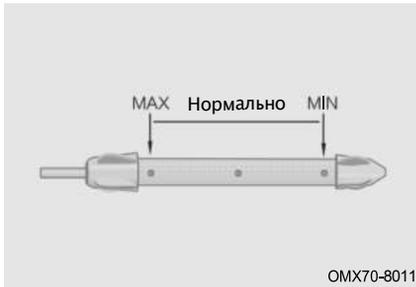
Подложите тряпку под щуп, чтобы масло не попало на двигатель или кузов автомобиля.
