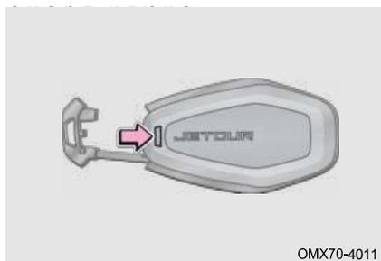
Шаг 1: Механический ключ, встроенный в смарт-ключ. Нажмите кнопку фиксатора на задней стороне смарт-ключа, чтобы вынуть механический ключ.
