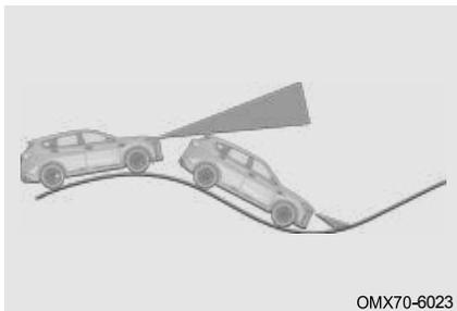
Не используйте ACC систему на крутом склоне. На крутом склоне ACC система не может обнаружить автомобили, движущиеся по той же полосе. На крутом склоне водитель обычно управляет автомобилем, чтобы ускориться и затормозить. При нажатии на тормоз ACC система отключается.
