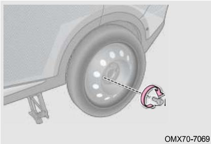
Шаг 2: При установке колесных болтов вкручивайте их во все отверстия колесных дисков по часовой стрелке вручную. Затем выпрямите запасное колесо и предварительно затяните все колесные болты с помощью ключа для колесных болтов;
