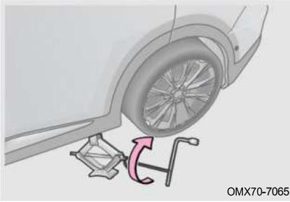
Шаг 4: Когда выемка домкрата коснется правильной точки подъема, вставьте коромысло домкрата в домкрат, а затем установите ключ для колесных болтов в коромысло домкрата и поверните ключ для колесных болтов по часовой стрелке, чтобы поднять автомобиль;
