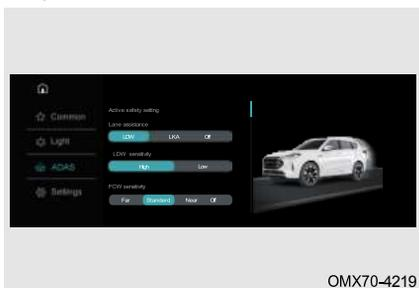
Включите/выключите систему предупреждения о выезде с полосы движения и систему помощи при удержании полосы движения в аудиосистеме.
