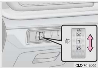
Включите питание автомобиля в режиме ВКЛ, при включенном ближнем свете фары можно регулировать в зависимости от количества пассажиров и загрузки автомобиля.
