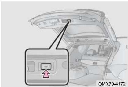
Когда дверь багажного отделения с электроприводом откроется, нажмите внутренний переключатель двери багажного отделения «
