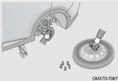
Шаг 1: Снимите все приспособления с монтажной поверхности. Убедитесь, что ступица колеса хорошо прилегает к поверхности колеса, и установите запасное колесо;
