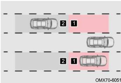
Когда передача трансмиссии находится в положении D и скорость автомобиля составляет не менее 15 км/ч, активируется система BSD.
