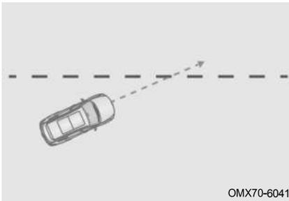
При увеличении скорости до 60 км/ч и выше активируется LDW система; Когда скорость автомобиля ниже 60 км/ч, LDW система переходит в режим предварительной активации.
