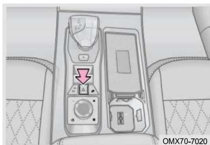
Нажмите выключатель аварийной сигнализации, одновременно замигают указатели поворота и индикатор указателей поворота на приборной панели; Нажмите переключатель еще раз, указатели поворота и индикатор погаснут.
