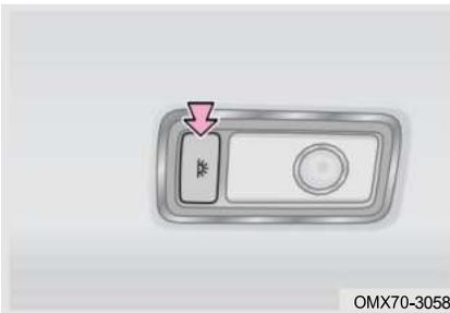
Нажмите переключатель потолочного освещения второго ряда, загорится индикатор карты второго ряда; нажмите переключатель еще раз, чтобы выключить свет.
