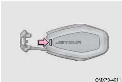
Механический ключ, встроенный в смарт-ключ, можно использовать для разблокировки /заблокировки дверей в экстренных случаях после нажатия кнопки разблокировки на обратной стороне смарт-ключа и извлечения механического ключа (подробности см. в разделе «Дверь»). После использования верните его на прежнее место для удобства переноски.
