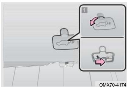
Дверь багажного отделения не может быть открыта, когда батарея разряжена или в подобных условиях. В этом случае откройте дверь багажного отделения с помощью переключателя аварийного устройства двери багажного отделения (остановите автомобиль как можно безопаснее, если позволяют условия).
