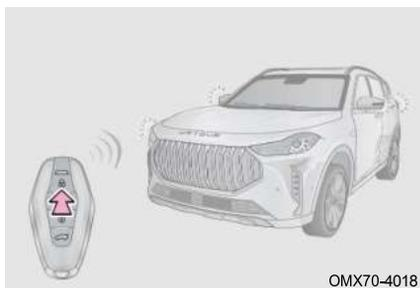
Когда питание автомобиля переведено в режим выключения, а четыре двери и дверь багажного отделения закрыты, нажмите кнопку блокировки смарт-ключа или прикоснитесь пальцами к сенсорной области блокировки или покиньте автомобиль, имея при себе смарт-ключ, дверь автоматически заблокируется и перейдет в режим постановки на охрану.
