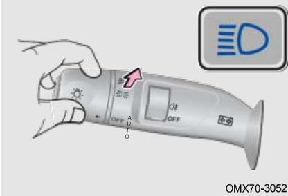
Переведите питание автомобиля во включенный режим, потяните комбинированный переключатель фар к рулевому колесу и отпустите его, чтобы один раз включить фары дальнего света. В то же время индикатор дальнего света фар в комбинации приборов мигает один раз.
