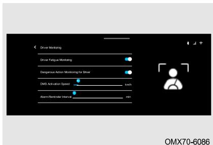
Система мониторинга водителя может включать / выключать соответствующие функции аудиосистемы, а также активировать настройку скорости и времени срабатывания будильника.
