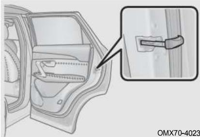
Вставьте механический ключ в отверстие механического переключателя, поверните по часовой стрелке, чтобы заблокировать переднюю правую дверь/дверь второго ряда; поверните против часовой стрелки, чтобы разблокировать переднюю правую дверь/дверь второго ряда.
