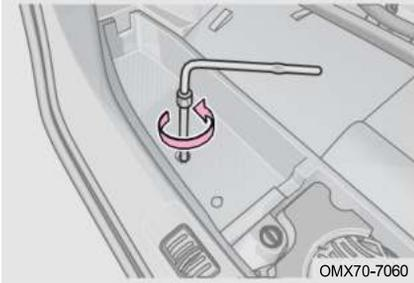
Шаг 1: Откройте дверь багажного отделения, приподнимите ковер в багажном отделении и достаньте ящик для хранения в багажном отделении;
