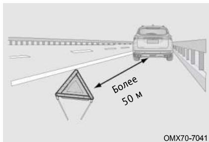
На обычной дороге поместите знак аварийной остановки на расстоянии более 50 м позади автомобиля.
