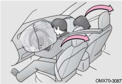
1. Преднатяжитель ремня безопасности предназначен для помощи фронтальной подушке безопасности (SRS) в случае сильного удара.
