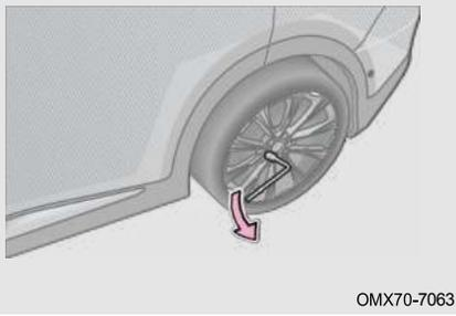
Шаг 2: Подсоедините ключ для колесных болтов к колесному болту спущенной шины, установите рукоятку с левой стороны, возьмитесь за конец рукоятки ключа и надавите на нее вниз, ослабьте каждый болт спущенной шины примерно на пол-оборота;
